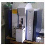
Fig. 8. Spectrometer BRUKER Q4 TASMAN
