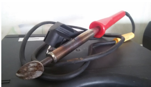
5. att. Lodāmurs ar plakano galvu
