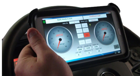
2. att. Bremžu stendu vadības aplikācijas: a – BM Test Equipment BM20200; b – Sherpa BPS Mobile
