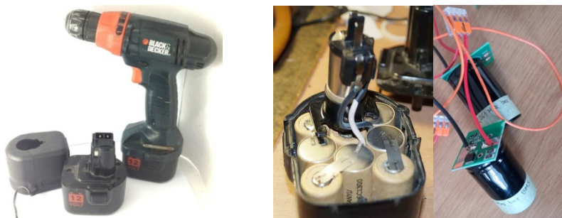
3. att. Akumulatora skrūvgriezis, nolietots akumulators pirms pārbūves un superkondensatori testa slēgumos
