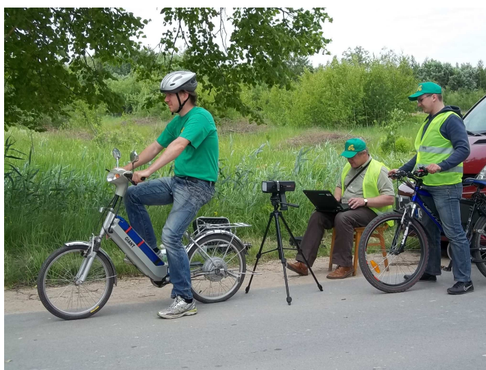
6.22. att. Elektrovelosipēda ieskriešanās parametru noteikšana, izmantojot zinātnisko radaru Stalker ATS
