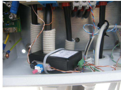
3.108. att. UIT mēritājs ar pievienotu atslēdzēju saules bateriju sprieguma mērīšanai
