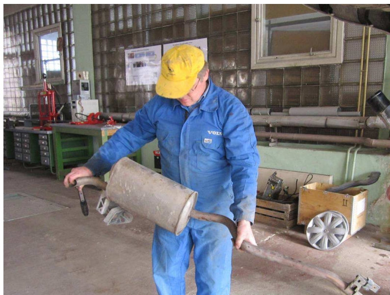
4.54. att. Izpūtēja pakalējās daļas demontāža
