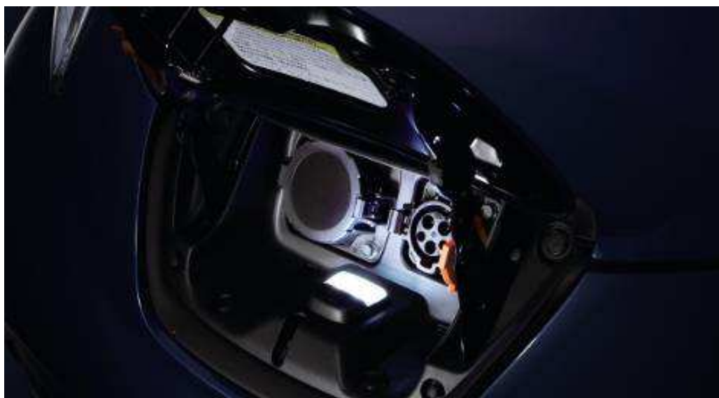
1.131. att. Lādēšanas pieslēguma vieta
