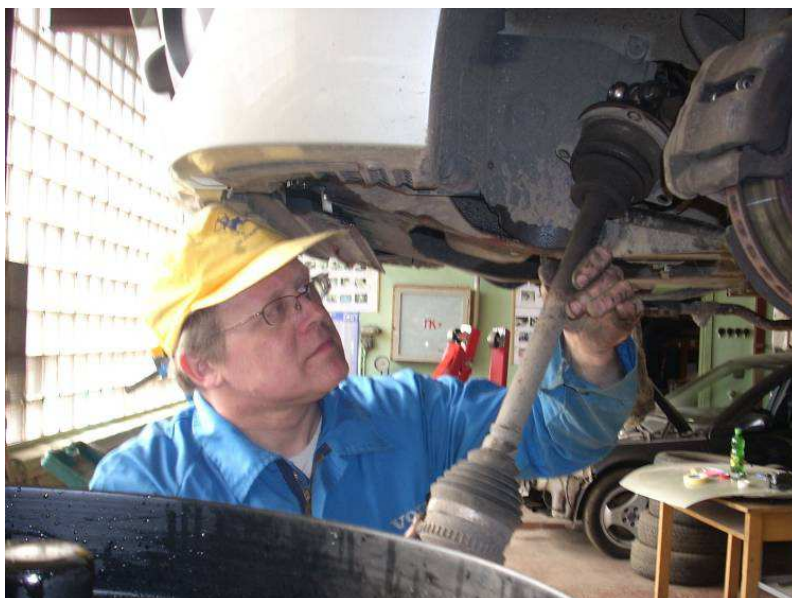
4.57. att. Pusasu demontāža
