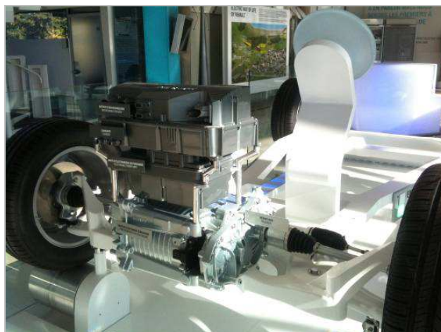
1.157. att. Fluence Z.E. motora un jaudas piedziņas elementu novietojums
