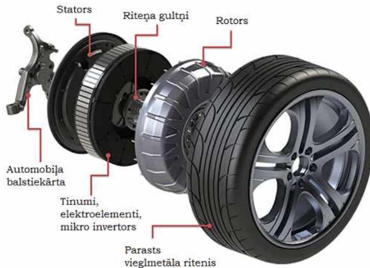
1.87. att. Ritenī izvietots elektromotors
