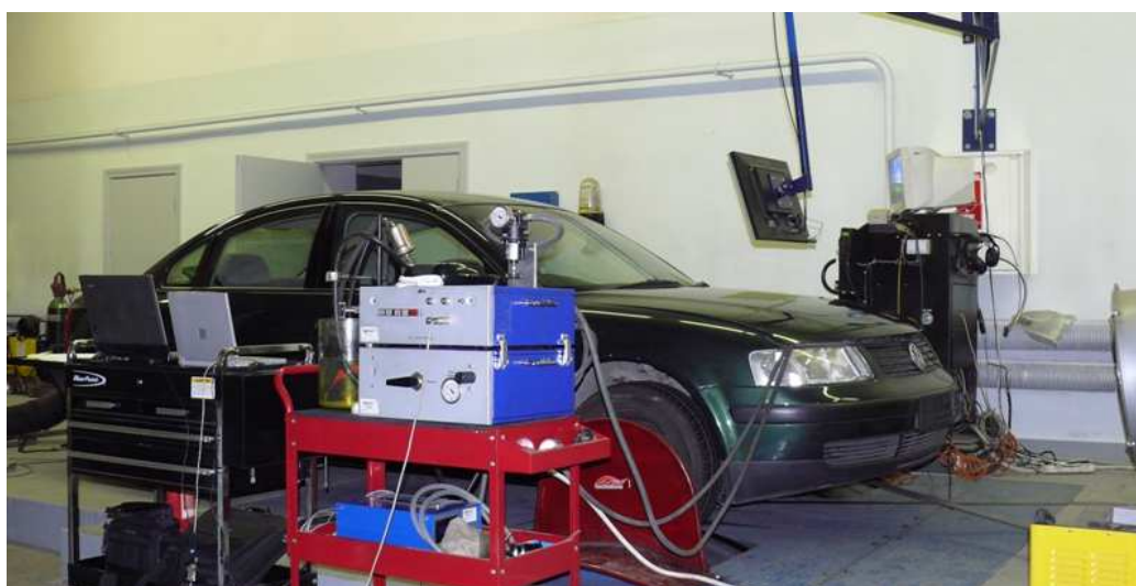
3.28. att. Eksperimentālais automobilis bioetanola benzīna maisījumu degvielu izpētei
