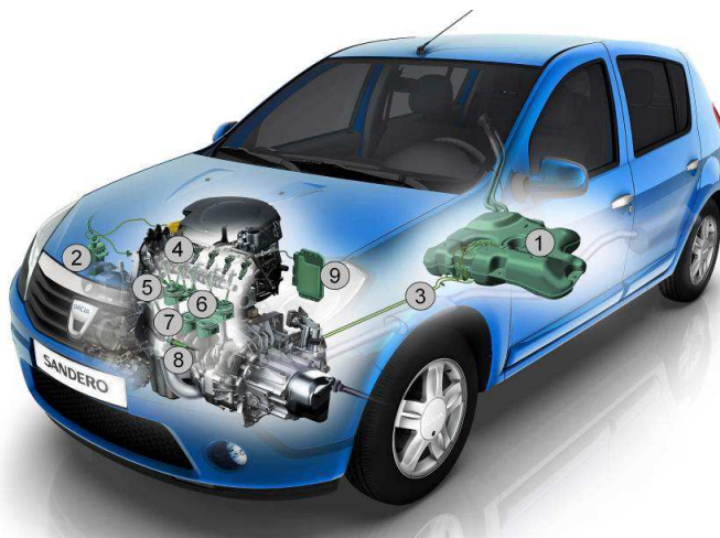
3.27. att. Dacia Sandero E85 maināmas degvielas automobilis (Nouvelles motorisations ..., 2009): 1 - degvielas tvertne; 2 - degvielas filtrs; 3 - degvielas cauruļvadi; 4 - sprauslas; 5 - aizdedzes sveces; 6 - vārsti un vārstu sēžas; 7 - virzuļi un gredzeni; 8 - skābekļa devējs; 9 - vadības bloks
