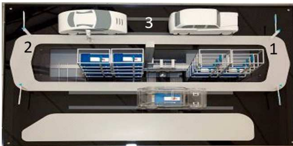
1.168. att. Bateriju nomaiņas stacijas modelis: 1 - izlādētās baterijas; 2 - uzlādētās baterijas; 3 - nomaiņas līnija
