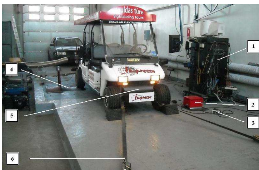
6.27. att. Melex 963DS uz jaudas stenda: 1 - vadības iekārta; 2 - lādētājs; 3 - REV datu vācējs; 4 - jaudas stenda ruļļi; 5 - eksperimenta objekts; 6 - siksnas
