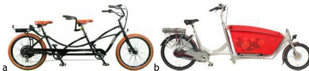
1.48. att. Divriteņu elektrovelosipēdi: a - tandēms; b - kravas elektrovelosipēds
