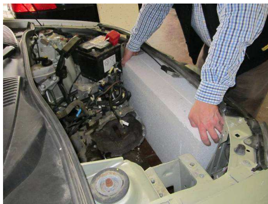
4.69. att. Renault Clio motortelpas priekšējās daļas akumulatoru modelēšana
