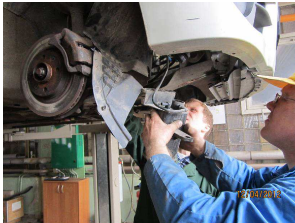
4.62. att. Degvielas tvaiku filtra demontāža
