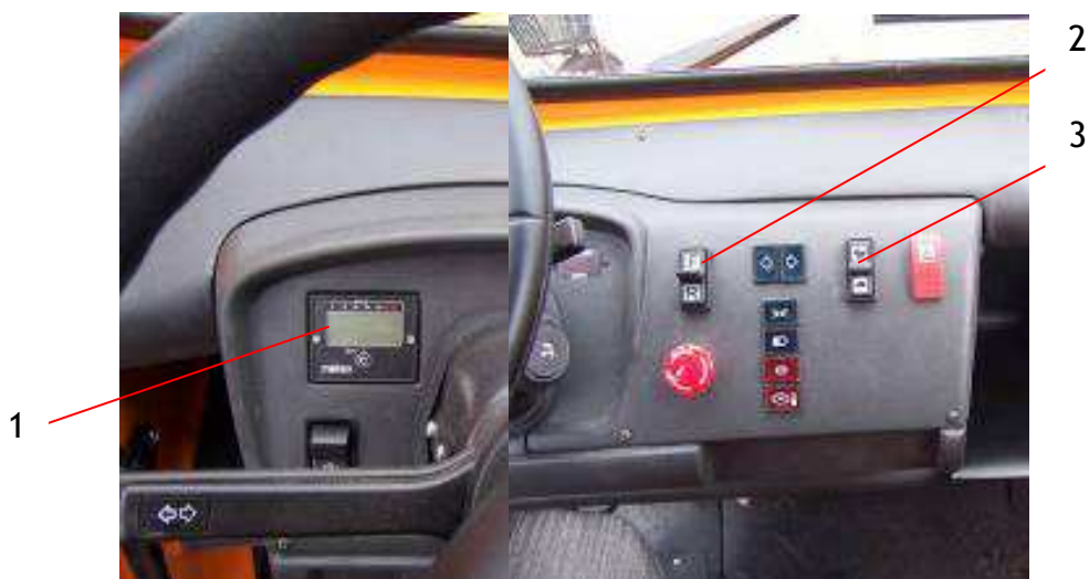
1.31. att. Centrālā informācijas un vadības sistēma: 1 - salonā integrēts displejs; 2 - automobiļa reversīvās kustības slēdzis; 3 - braukšanas režīma vadības slēdzis
