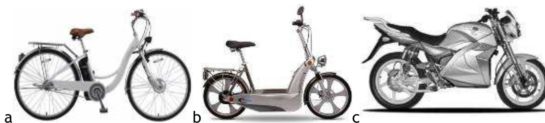
1.47. att. Divriteņu elektropēkrati: a - velosipēds; b - mopēds; c - motocikls
