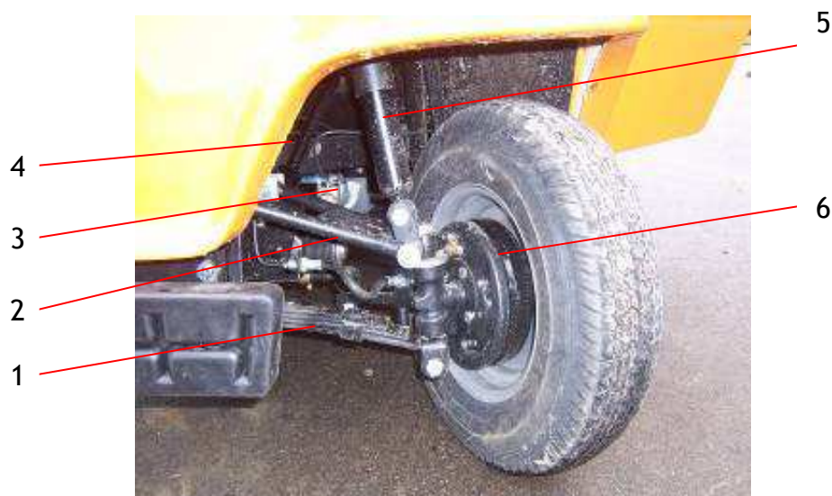
1.33. att. Elektroautomobiļa MELEX priekšējā balstiekārta: 1 - lokšņu atspere; 2 - trapeceveida balstiekārtas augšējais plaukts; 3 - galvenais bremžu cilindrs; 4 - stūres stienis; 5 - amortizators; 6 - bremžu trumulis
