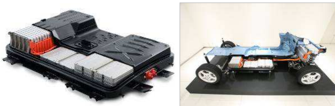
1.130. att. Bateriju moduļu izvietojums
