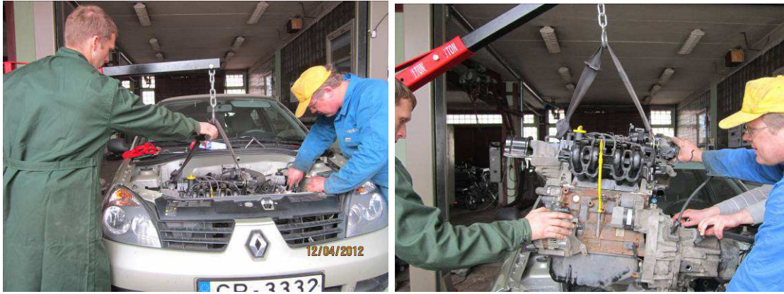
4.60. att. Motora izcelšana no automobiļa
