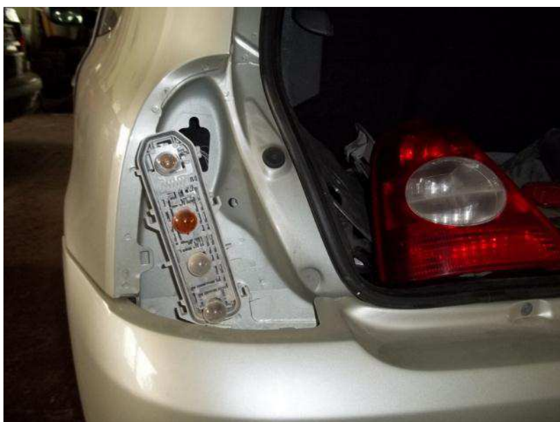
4.70. att. Pakaļējo gabarītlukturu, bremžu gaismu, pagriezienu un miglas gaismu jaudas noteikšana
