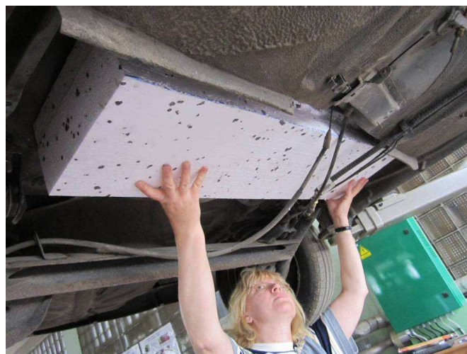
4.66. att. Bateriju modeļa piemērīšana degvielas tvertnes vietā
