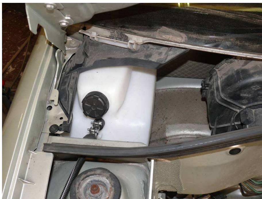
4.82. att. Bioetanolā tvertnīte salona apsildes sistēmai
