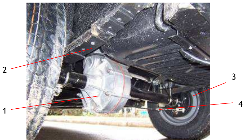
1.32. att. Elektroautomobiļa MELEX pakaļējais tilts: 1 - galvenais pārvads; 2 - lokšņu atspere; 3 - bremžu trumulis; 4 - stāvbremzes trose
