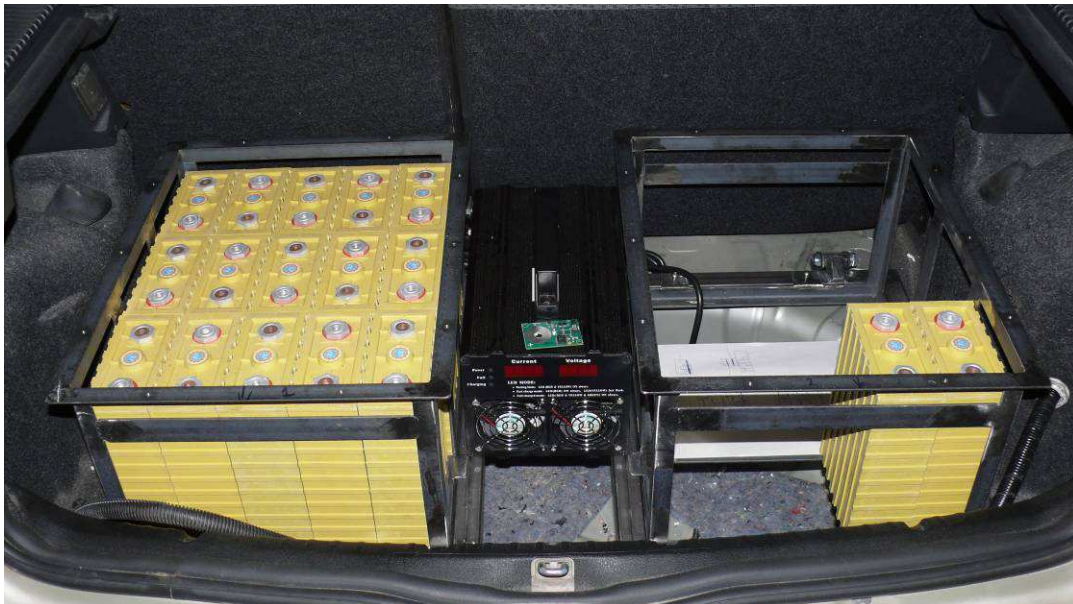
4.84. att. Akumulatoru baterijas montāžas stadijā elektromobiļa bagāžas nodalījumā
