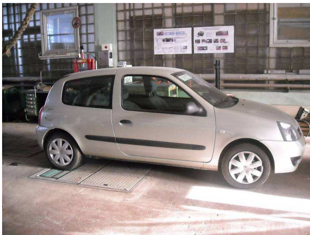
4.50. att. Automobilis novietots slodzes noteikšanai uz pakalējiem riteņiem
