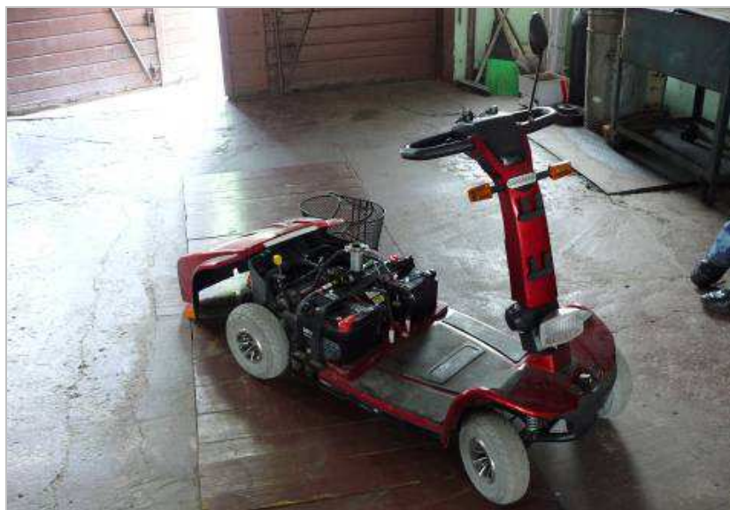
1.20. att. Iepirkšanās elektromobilis ar noņemtu sēdekli un bateriju plastmasas aizsargu
