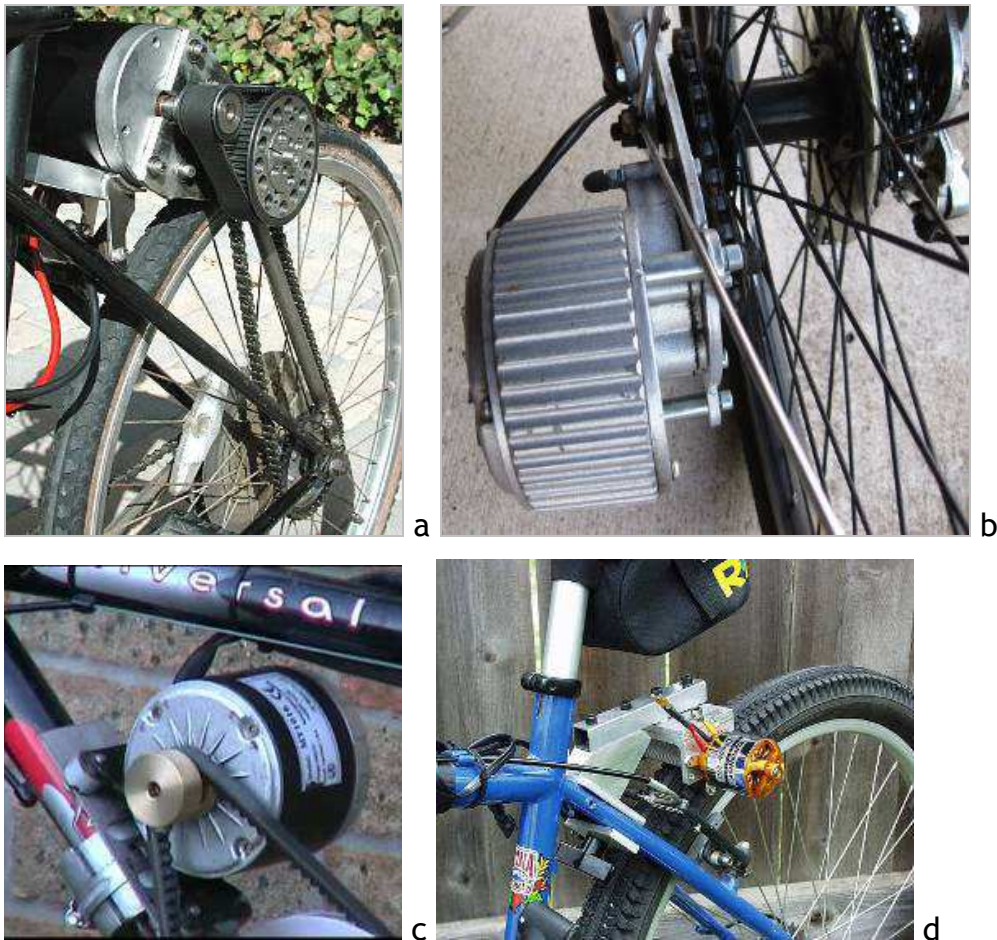
1.55. att. Elektrovelosipēda piedziņas veidi: a - divpakāpju zobsiksnas-ķēdes; b - divpakāpju ķēdes; c - zobsiksnas; d - frikcijas
