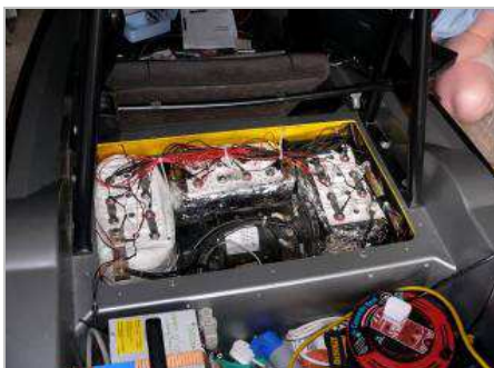
1.23. att. 43 V 100 Ah litija jonu akumulatoru baterijas modernizētajā City EL
