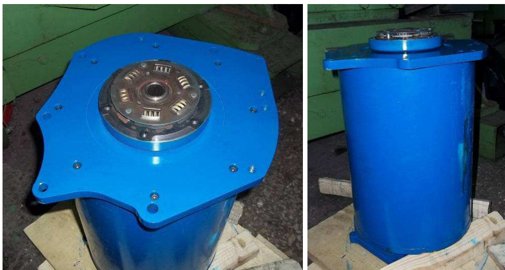
4.74. att. Elektromotors ar samontētu atloku un transmisijas pārejas mezglu
