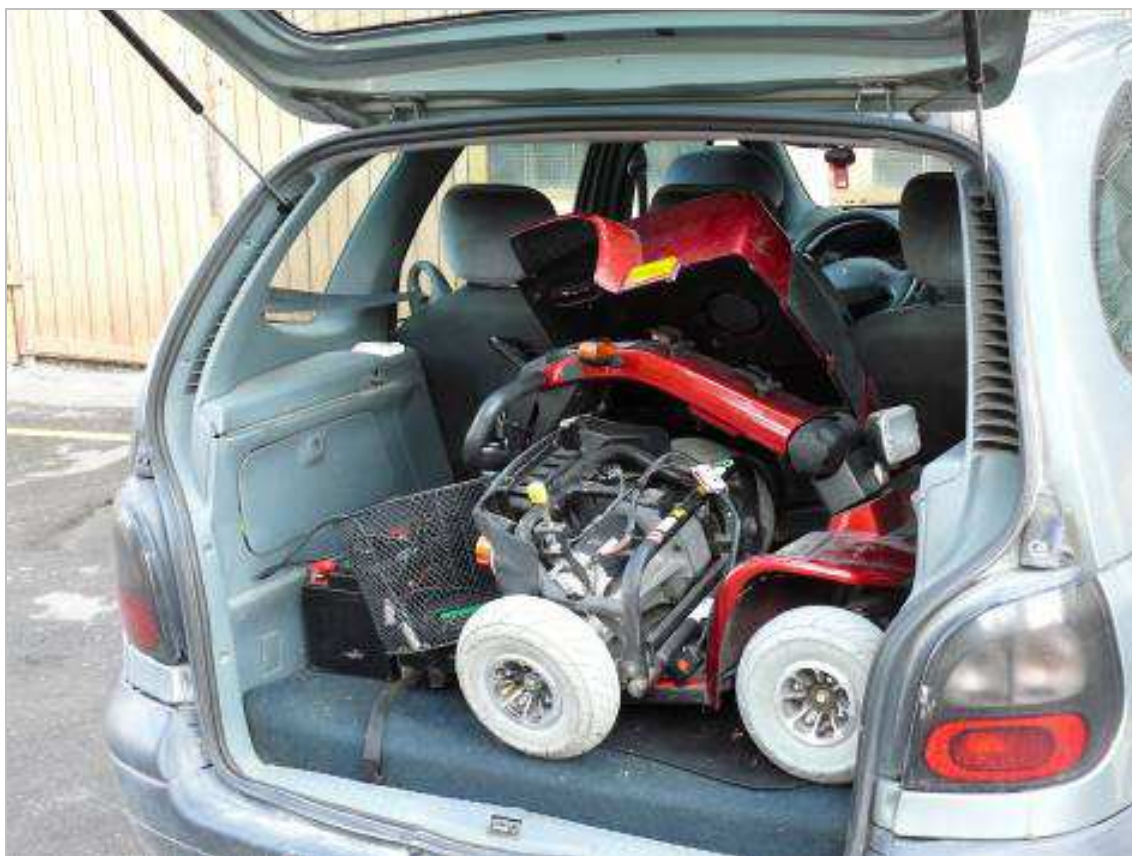
1.15. att. Iepirkšanās elektromobilis novietots izjauktā veidā automobiļa bagāžas nodalījumā
