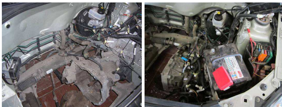
4.68. att. Pārbūvējamajā automobilī montētā ātrumkārbā un akumulators
