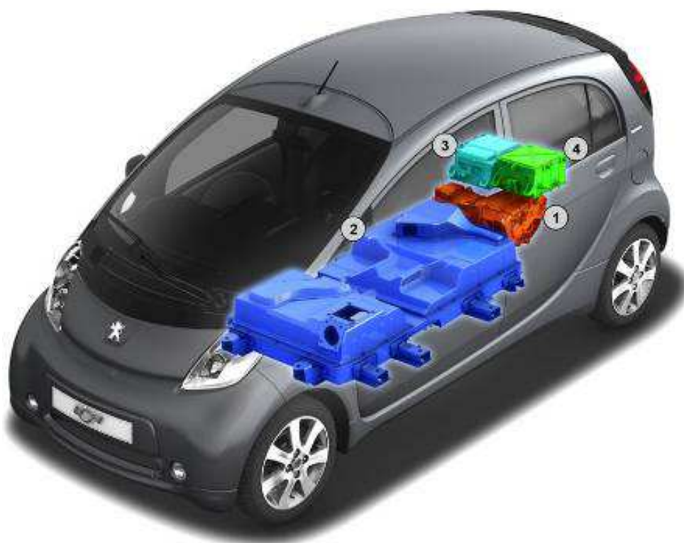
1.149. att. Komponenšu novietojums: 1 - elektromotors; 2 - bateriju nodalījums; 3 - inverters; 4 - lādētājs
