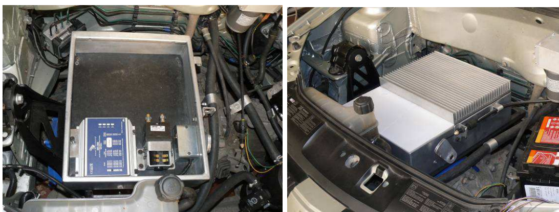
4.79. att. Elektrodaļas mezglu montāža kārbā: a - kārba bez invertora; b - kārba ar samontētu invertoru
