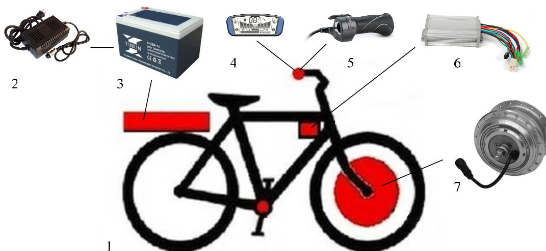
1.51. att. Elektrovelosipēda uzbūve: 1 - elektrovelosipēda kopskats; 2 - lādētājs; 3 - akumulatoru baterija; 4 - vadības displejs; 5 - drosele; 6 - kontrolle; 7 - elektromotors
