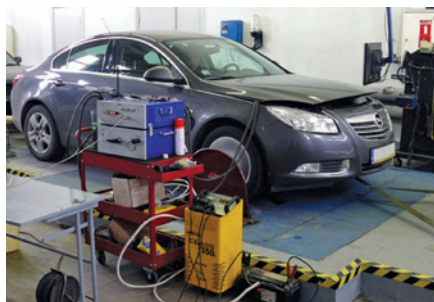
Automobiļa testi ar NEXBTL degvielu Spēkratu institūta Alternatīvo degvielu zinātniskajā laboratorijā.
