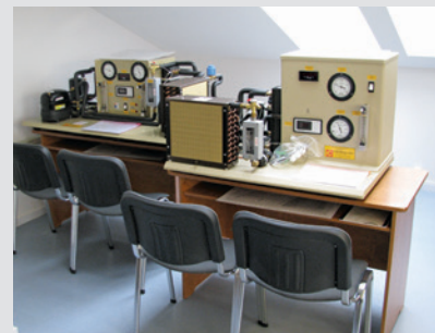
Siltumsūkņu izpētes iekārta Termoprocesu laboratorijā.
