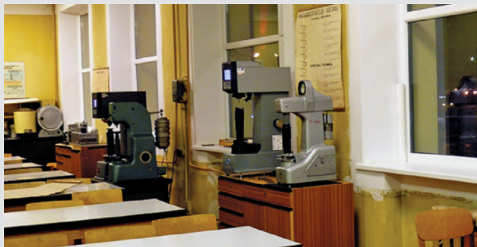
Metalogrāfijas laboratorijā ir iegādātas vairākas jaunas iekārtas materiālu cietības noteikšanai ar Brinēļa un Rokvela metodēm.
